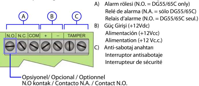
Şekil/Figura 4 PCB Genel Bakış / Vista General / Vue d'ensemble
